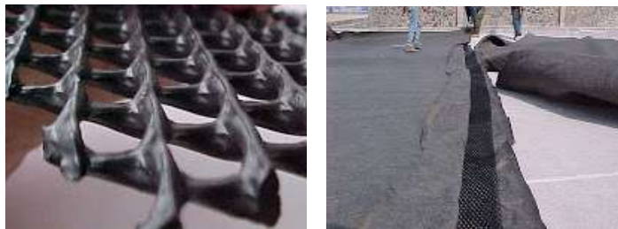
Fig. 6 Geodren prefabricado con geotextil por las dos caras.
